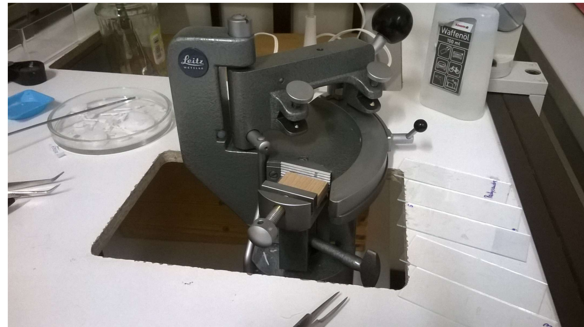
„Herzstück“ des Kurses: das Leitz-Schülermikrotom zum Erstellen von botanischen Dünnschnitten.
